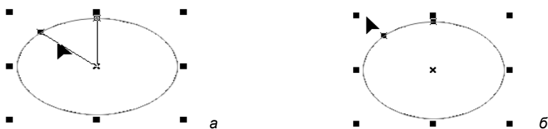
Рис. 2.4. Построение: а — сектора; б — дуги
