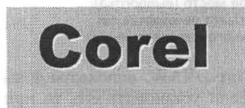
Рис. 14.20. Результат несовмещения красок при печати
